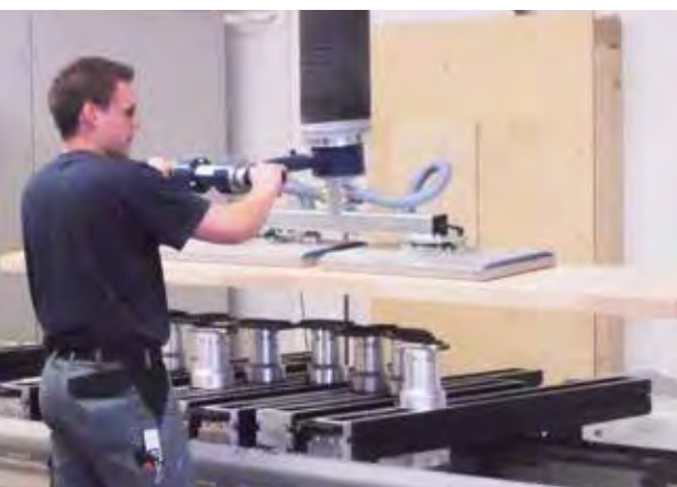
Handling von Holzbalken mit VUSS-Saugfuß
