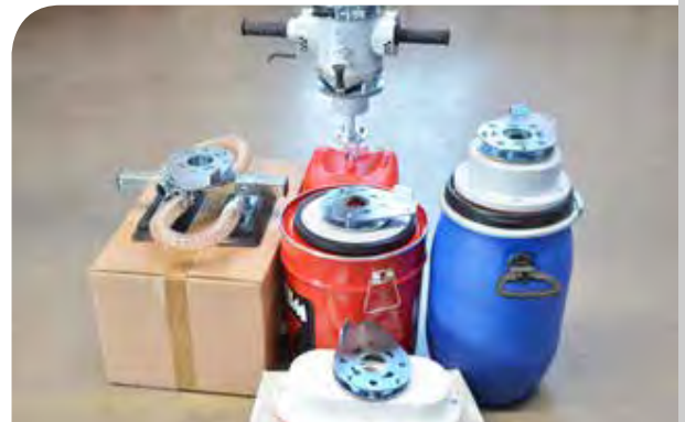
Schnellwechselkupplung für verschiedene Lastaufnahmen
