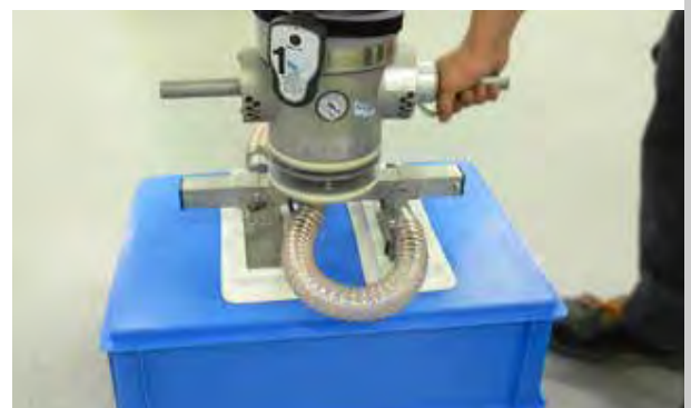
Bedienkopf in V2A mit Funksender
