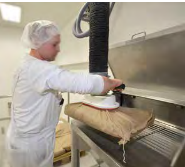
Handling von Säcken im Ex-Schutz-Bereich
